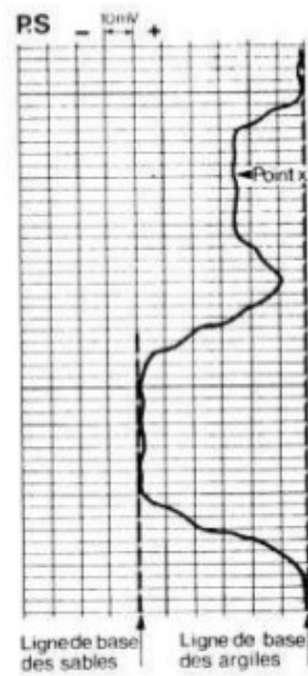
Figure 11 : Calcul du pourcentage d'argile : déflexion P.S. sable = 60 mV, déflexion P.S. sable argileux = 25 mV. V_{sh} = (60-25)/60 = 0.58
